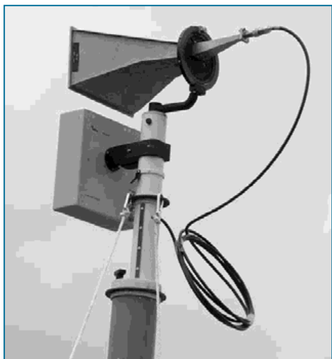
Фото 2. Выносной конвертор АРК-КНВ4И и измерительная антенна на диэлектрической мачте
