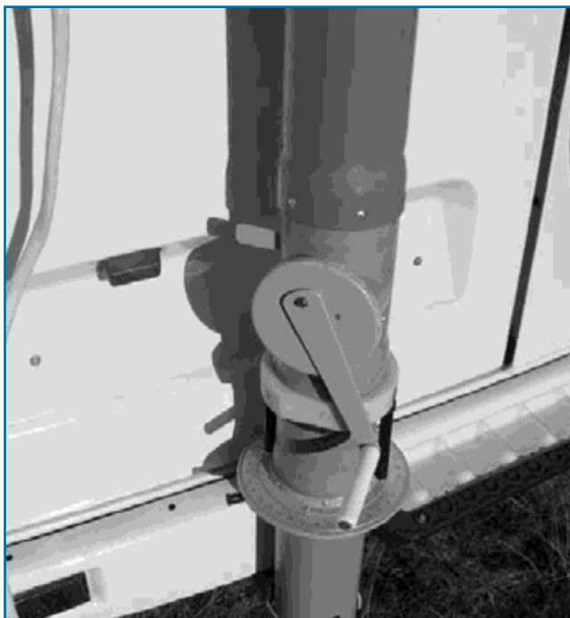
Фото 4. Подъемно-поворотный механизм диэлектрической мачты
