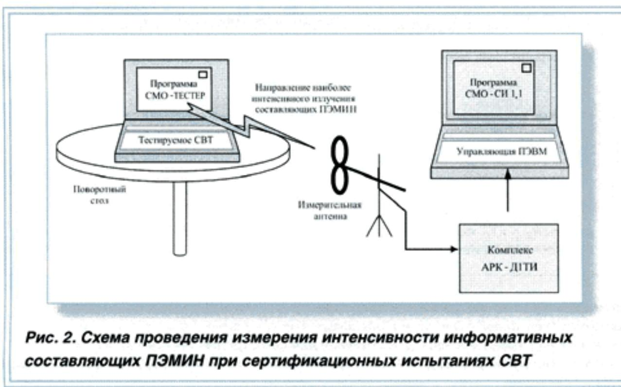
**Рис. 2. Схема проведения измерения интенсивности информативных составляющих ПЭМИН при сертификационных испытаниях СВТ**
