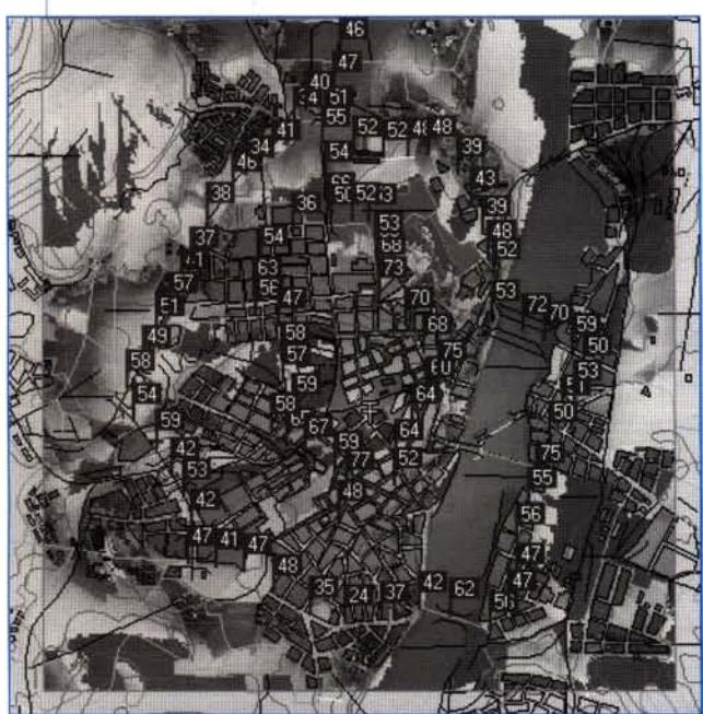
**Рис. 6. Уточненное распределение напряженности поля сигнала по результатам измерений**
