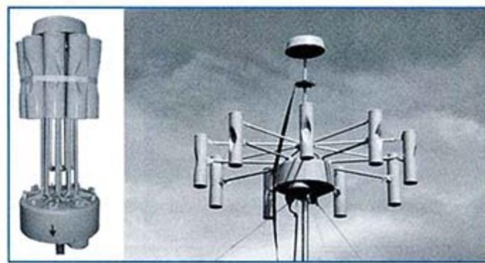
Фото 1. Антенная система АС-ПП4 в сложенном и развернутом виде
