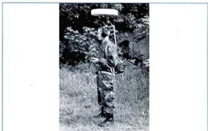
Фото 6. Носимый пеленгатор Артикул Н1 с антennaй системой АС-НП1 в рабочем положении
