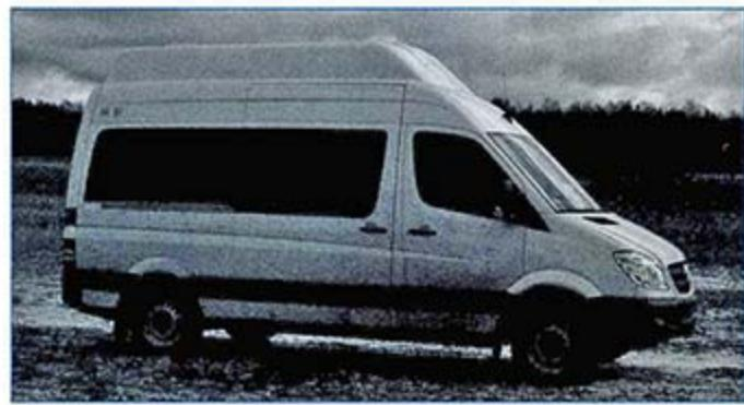
Фото 2. Антенная система АС-МП6 находится под общим обтекателем на всю крышу автомобиля
