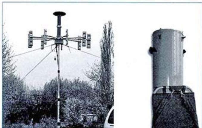
Фото 4. Антennaя система АС-ПП17 в развернутом состоянии и футляре для ее переноски
