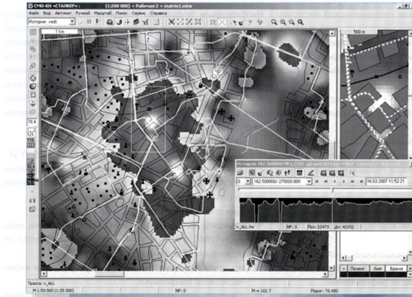
**Рис. 1. Отображение результатов измерений напряженности поля на карте местности**
