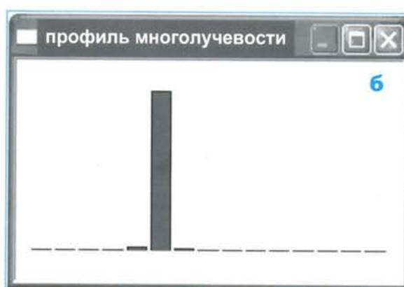
Фото 4. Пример оценки профиля многолучёвости: а – однолучевой канал; б – многолучевой канал
