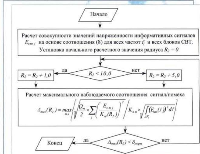
**Рис. 4. Структурная схема алгоритма расчета радиуса контролируемой зоны  $R_2$  при оценке защищенности СВТ от утечки информации по каналу ПЭМИ**
