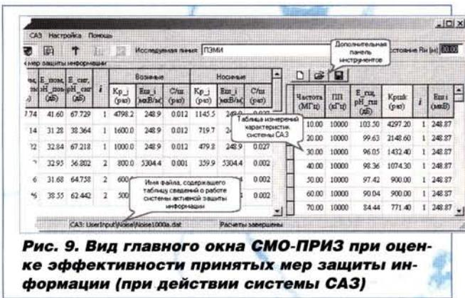
**Рис. 9. Вид главного окна СМО-ПРИЗ при оценке эффективности принятых мер защиты информации (при действии системы САЗ)**
