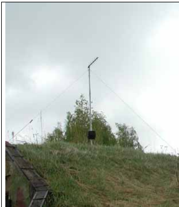
Рисунок 2. Радиомодем на мачте с направленной антенной
