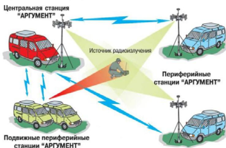
Рис 2. Мобильная система АРК-ПОМ2 радиомониторинга и определения местоположения ИРИ.
