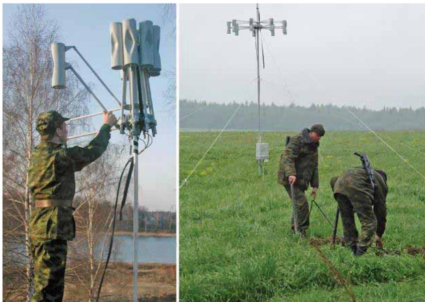
Рис 5. Антенная система АРК-МК7М
