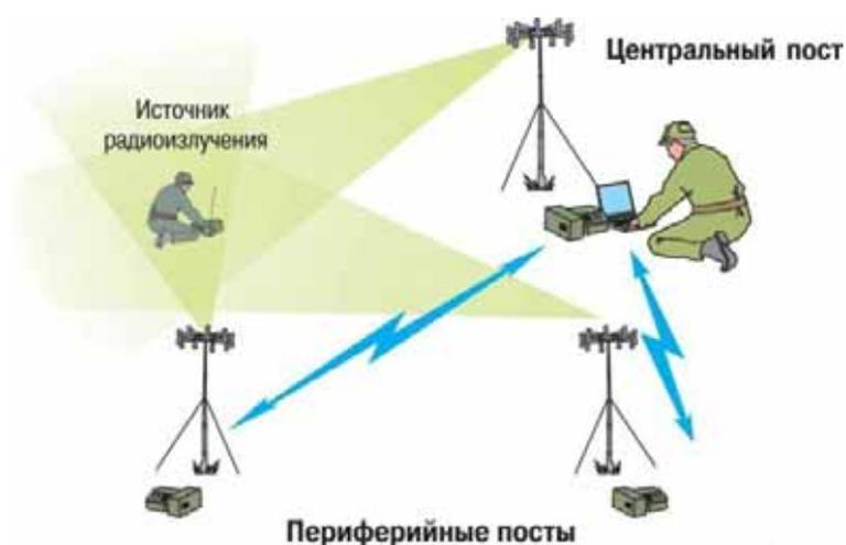
Рис 3. Портативная система АРК-ПОМЗ радиомониторинга и определения местоположения ИРИ
