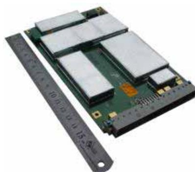
Рис 14. Одноканальный преобразователь сигнала АРК-ПС5
