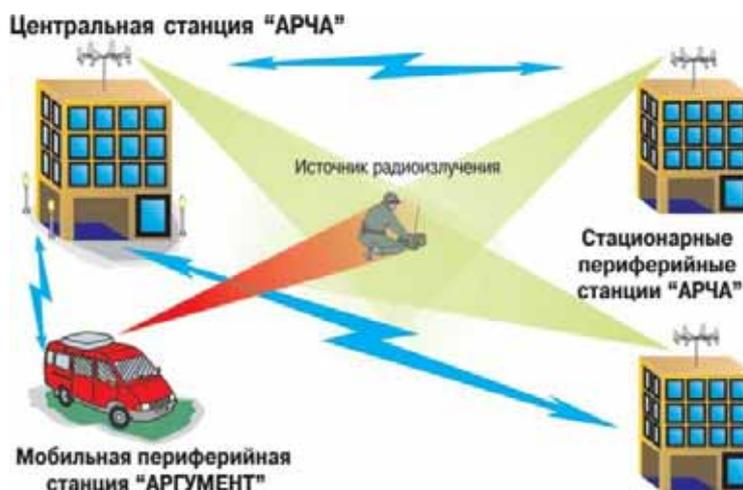
Рис 1. Система АРК-ПОМ1 радиомониторинга и определения местоположения ИРИ
