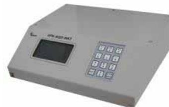
Рис 8. Внешний вид блока аналого-цифровой обработки АРК-АЦО-МК7
