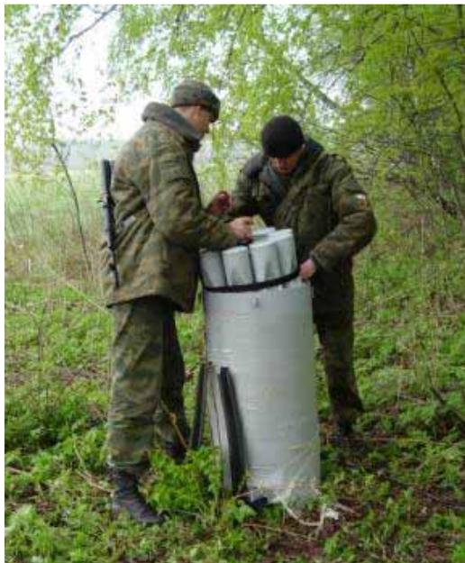
Рис 6. Укладка антенной системы АС-МК7М в чехол для переноски
