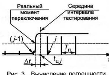
Рис. 3. Вычисление погрешности, вызываемой неточной фиксацией моментов смены состояния радиоканала
