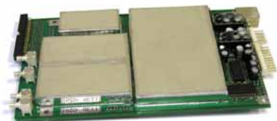
Печатная плата преобразователя сигналов АРК-ПС5 для установки в изделие пользователя
