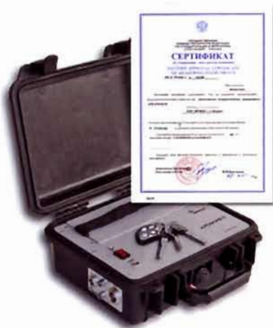
Рис. 2. Приемник измерительный панорамный «АРГАМАК-И»
