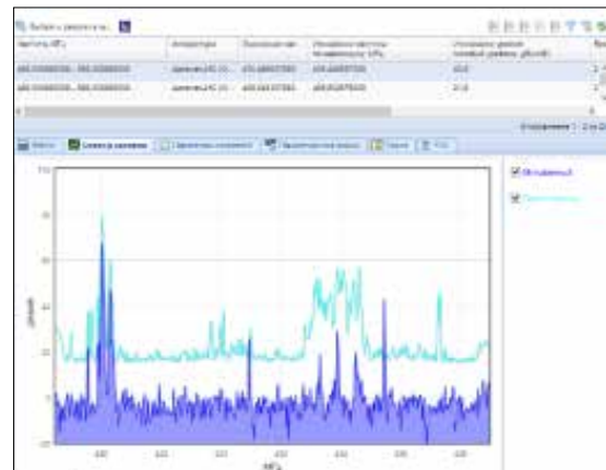
РИСУНОК 7.8. Обнаружения сигнала по событию РК (выход сигнала за маску)
