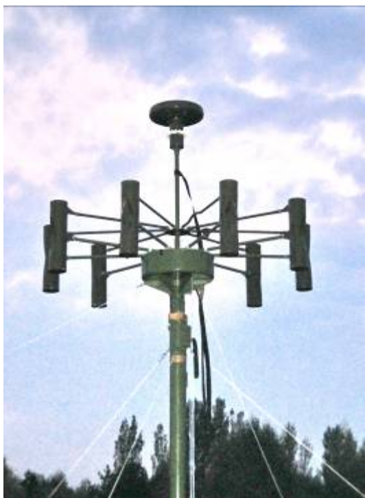
Рисунок (3). Антенная система для диапазона частот 25 - 3000 МГц с преобразователем сигнала на ПЧ
