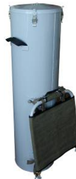
Рисунок (4). Переносная антенная система для диапазона частот 25 - 1000 МГц с преобразователем сигнала на ПЧ и пенал для переноски всех элементов антенны
