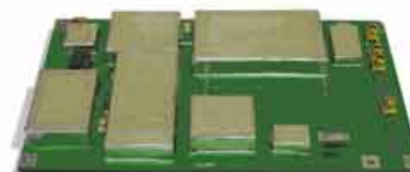
Рис. 3. Печатная плата тюнера для установки в готовое изделие
