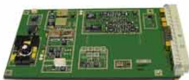
Рис. 2. Печатная плата тюнера без экранов в технологическом исполнении для регулировки
